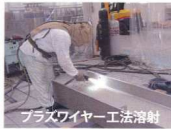
JIS溶射 (フレーム溶射)
